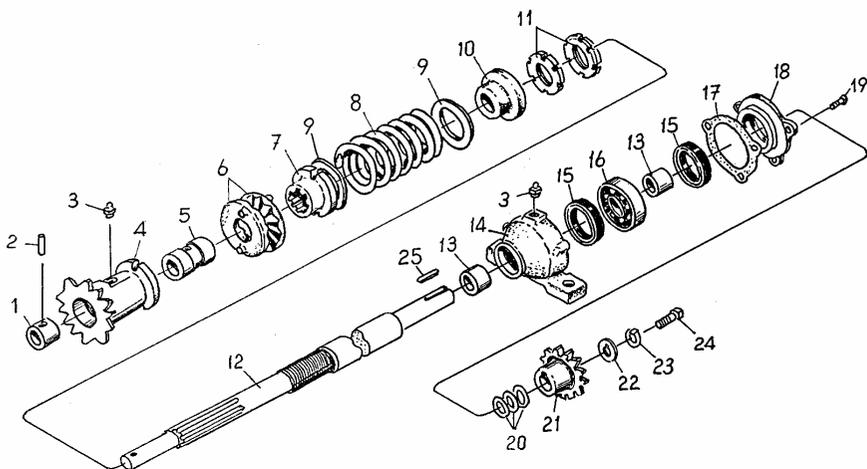
Рис. 7 Вал с муфтой КНТ 35.020
