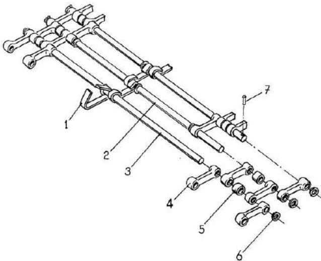
**Рис. 9. Полотно каскадного элеватора КНТ 30.250**
