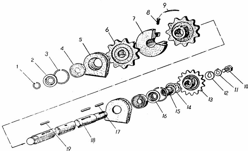
Рис. 3 Вал каскадного элеватора КНТ 30.010
